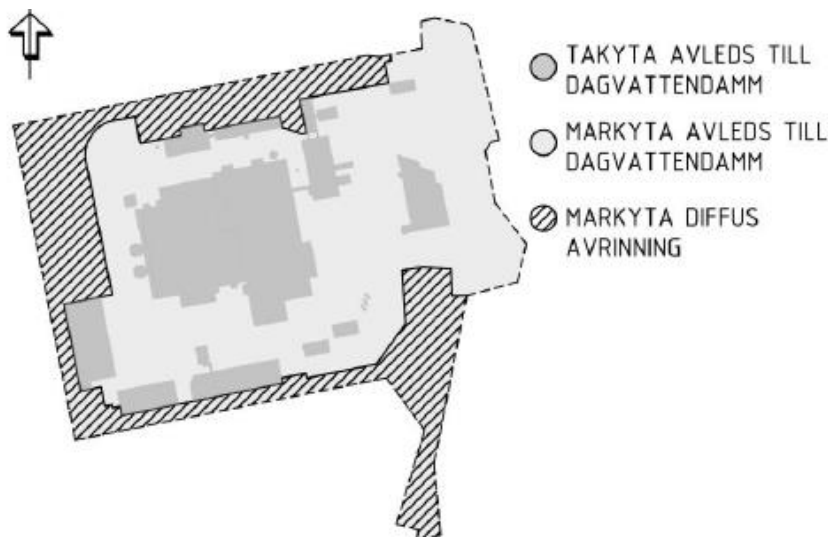
Förenklad figur som redovisar avrinning till dagvattendamm och diffusavrinning i planerad situation, hämtad från dagvattenutredningen 23-12-15.
