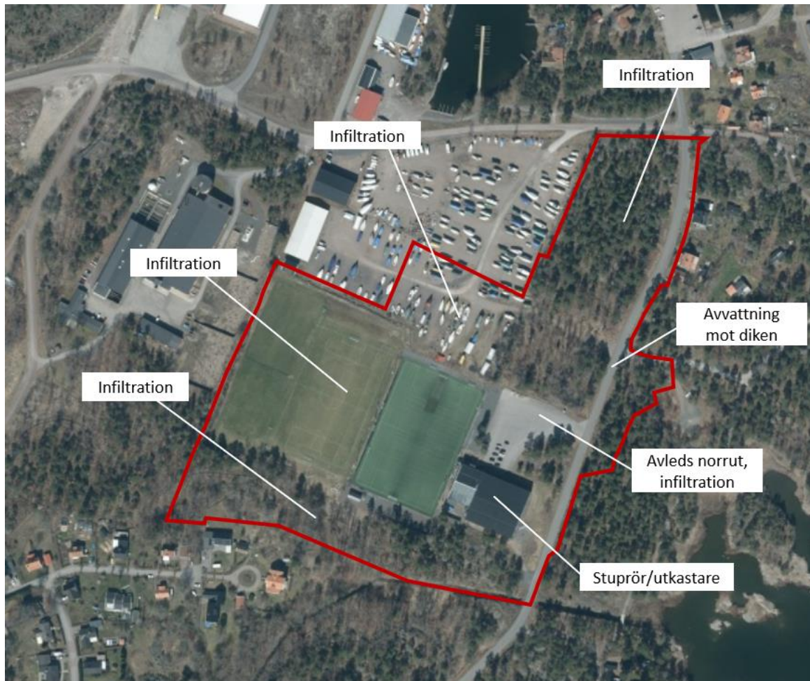
Figur 7. Illustration över befintlig dagvattenhantering, planområdesgräns ungefärligt markerad i rött.
