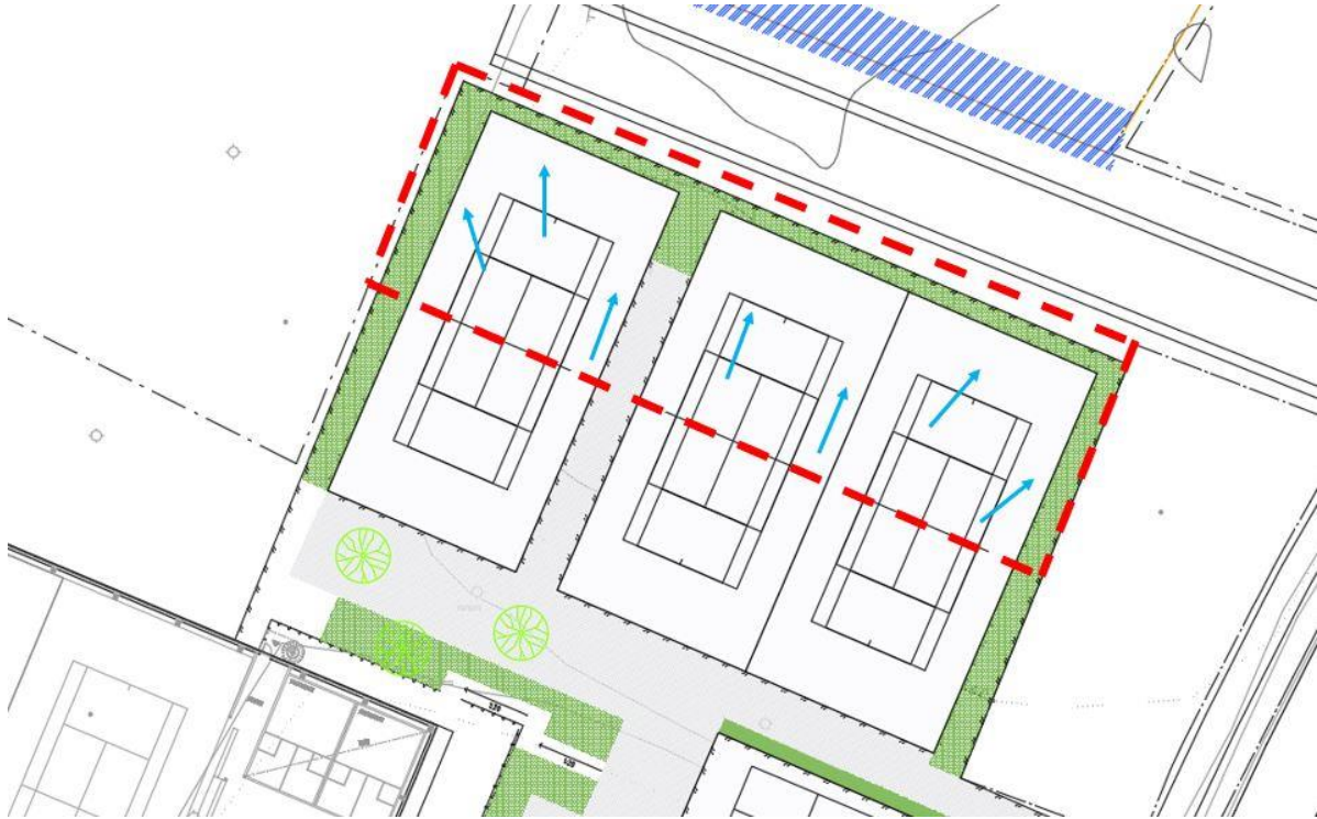
Figur 26. Dagvatten inom streckat område avleds med yttlig avrinning till grönytor norr om tennisbanorna, blå pilar visar approximerad flödesriktning.
