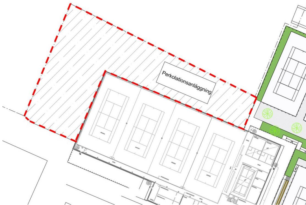
Figur 27. Befintlig grusad yta och föreslagen placering av perkolationsanläggning i grå-skrafferad yta.
