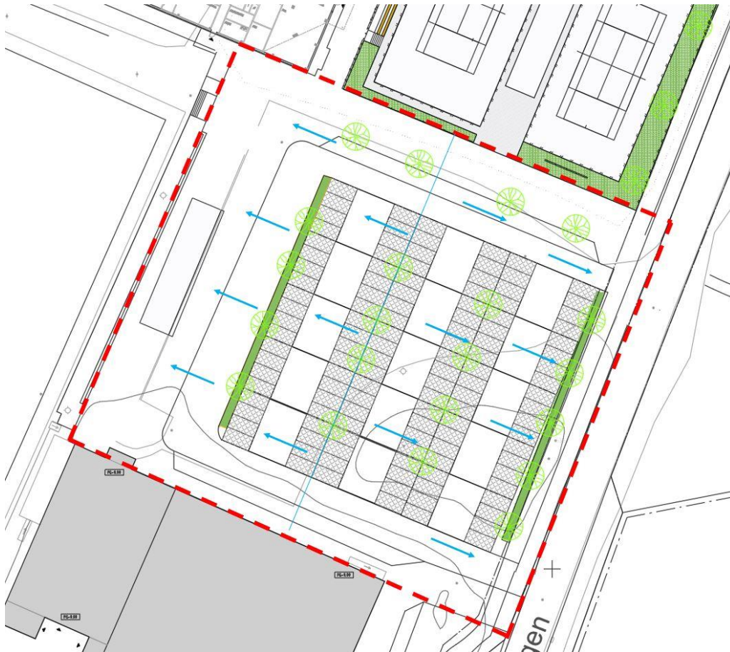
Figur 29. Dagvatten inom streckat område avleds med ytlig avrinning till skelettjordar längs Lotsgårdsvägen eller med ytlig avrinning i riktning mot fotbollsplanerna till skelettjordar.
