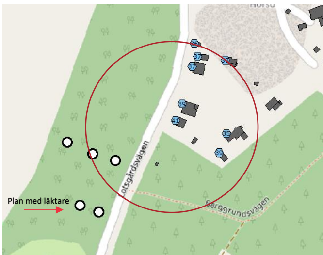
FIGUR 6 – RESULTAT FÖR BERÄKNING AV LJUD FRÅN 5 TENNISPLANER. DE VITA PUNKTERNA ÄR LJUD FRÅN TENNISPLAN. DEN RÖD CIREKLN ÄR CA 100M FRÅN NÄRMSTA FASAD
