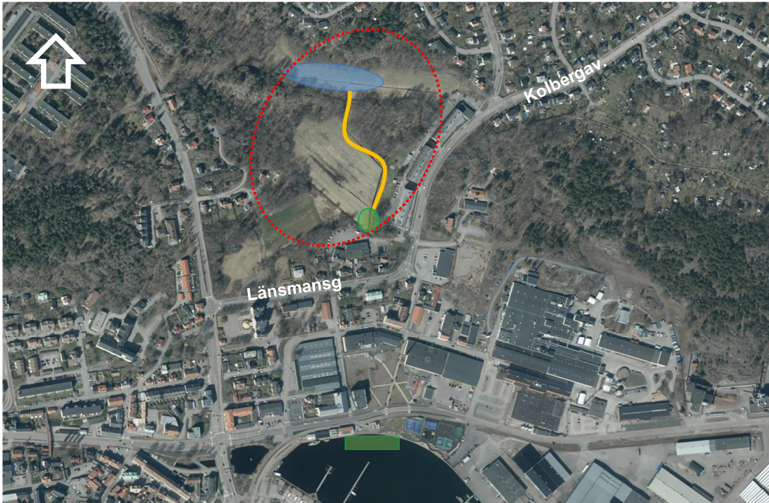
Figur 1. Blåmarkerad grönyta som utretts för fördröjning. Orange linje utgör öppet dike. Vid grön ring ansluter diket till ledningsnät för dagvatten.
